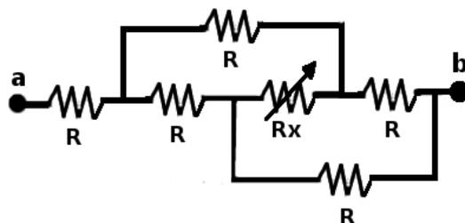
Quando  $R_x$  é ajustado para  $10\Omega$  a potência nele dissipada corresponde a que fração da potência total dissipada no circuito?
