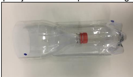
Figura 8: Marcação da posição dos furos para a mangueira de água na garrafa
