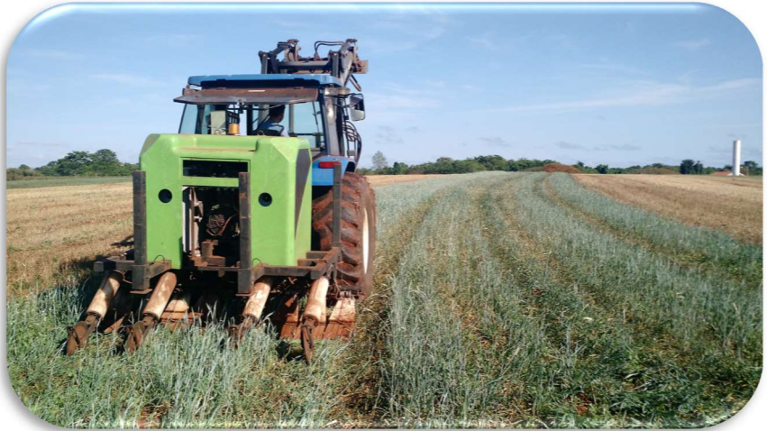
Figura 19. Manejo da cobertura vegetal de aveia preta IPR 61 com o equipamento Eletroherb da Sayyo (atualmente Zasso) na área experimental de agroecologia do CVT da Unioeste.
