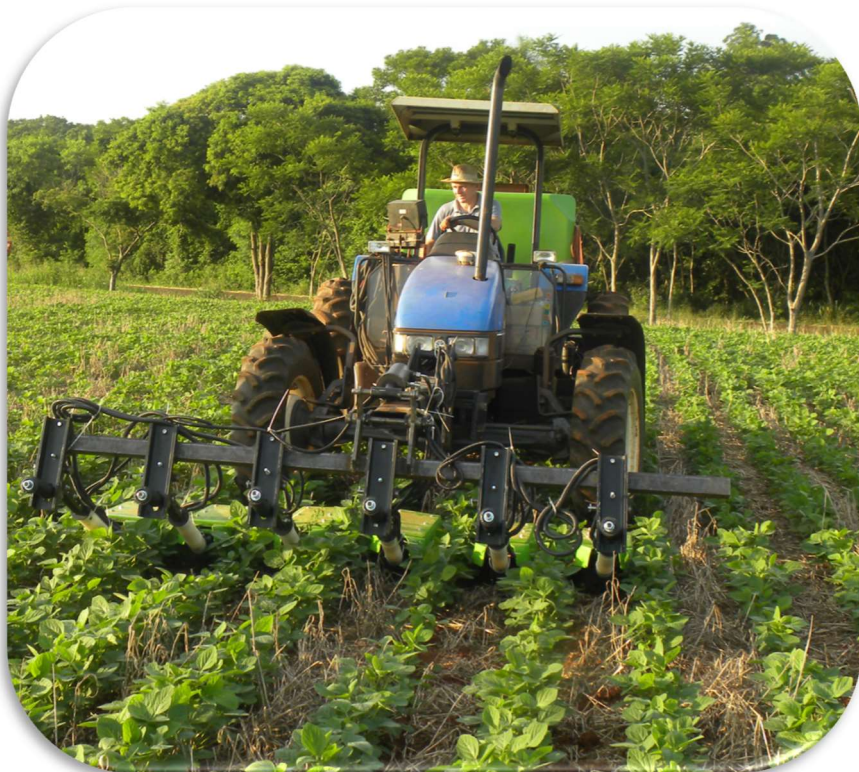
Figura 18. Protótipo do equipamento Eletroherb da Sayyo (atualmente Zasso do Brasil) adaptado para controle de plantas espontâneas na entre linha das culturas com eletrocussão em teste no CVT da Unioeste.
