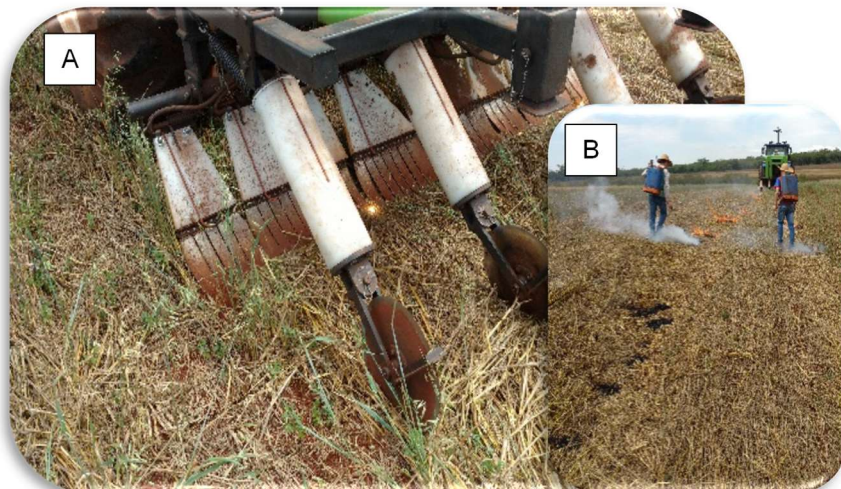
Figura 20. Centelhas do Eletroherb em operação sobre cobertura vegetal com presença de palha seca (A) e ocorrência de incêndios que precisaram ser controlados (B).
