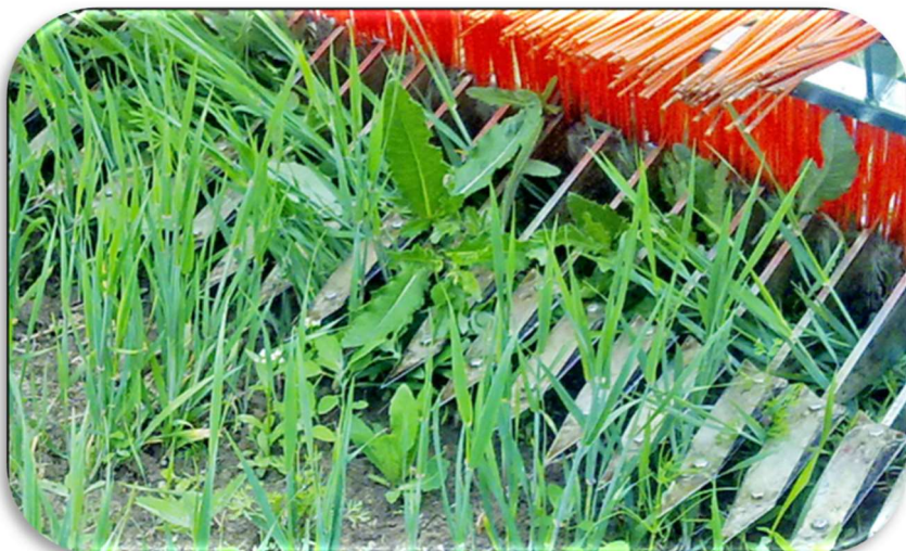
Figura 16. Máquina para o controle de plantas espontâneas em gramíneas composta por navalhas e molinete. Fonte da imagem inferior: https://www.agriculture-xprt.com/products/combcut-weed-cutter-365972
