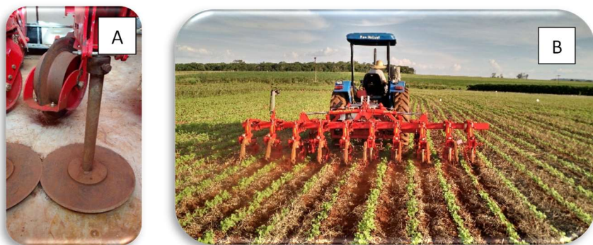
Figura 12. Linha de cultivo com disco horizontal fixado em eixo de giro livre e disco de corte com movimentação lateral (A) e cultivo na experimental de agroecologia em sistema plantio direto de manejo do solo (B) no CVT da Unioeste.
