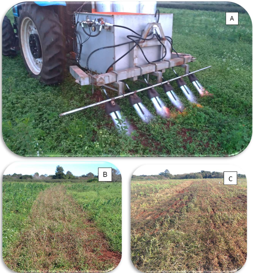
Figura 21. Máquina com queimadores de chama direta (A) e aspecto da cobertura vegetal após a realização de testes (B) e o manejo da área como um todo (C) na área experimental de agroecologia do CVT da Unioeste.
