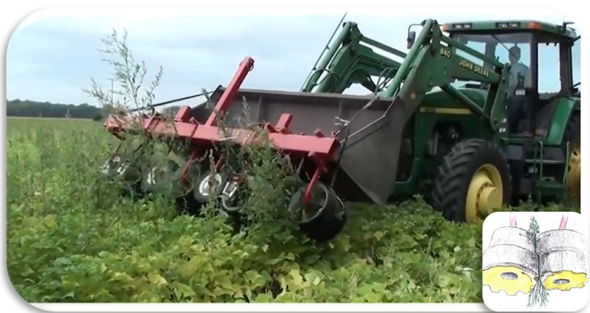
Figura 17. Máquina para arrancar plantas espontâneas (Weed puller) nas culturas. Fonte: https://www.youtube.com/watch?v=vFjYHZlrKfY
