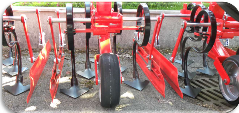
Figura 10. Linhas de cultivo da capinadora Austríaca com sistema de câmera para a visão das linhas da cultura e dispositivos eletrohidráulicos para direcionar os mecanismos de cultivo (capina) nas entre linhas da cultura na sua versão original.
