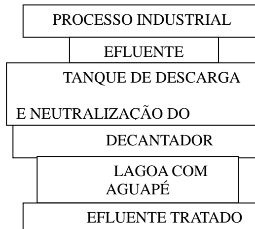
Figura 5 - Fluxograma de tratamento de efluentes de baterias.
