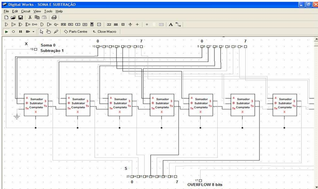
Figura10 – Circuitos combinatórios que realizam a operação de soma e subtração
