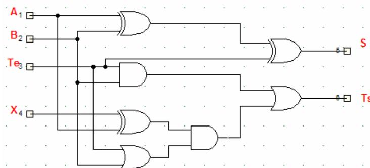
Figura 4 – Com o encapsulamento das portas lógicas acima e ampliando-o para o uso de mais bits, tem-se um somador completo
